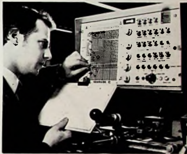
Pin-board programmering van het besturingsstelsel voor de automatische aanmaak van kaapstanders
